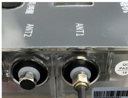
将天线按照下图安装在固定支架上，并在固定片上锁好螺丝。再用膨胀螺丝将支架固定在墙上（参考固定底板的安装），尽量靠近井盖口，以提升信号强度。若有疑问，请联系我司技术支持，提供详细指导。
