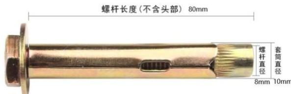
把膨胀螺母拧紧 2-3 圈后，感觉膨胀螺丝比较紧且在孔内不松动的情况下，拆下螺母及垫片，把固定底板的安装孔对准墙上的螺栓孔，装上垫片和螺母，用 14mm 扳手或者套筒拧紧螺母（螺栓不能高出固定底板的平面，否则影响后续主机与电池的安装）。
