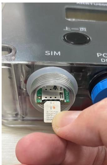
2、SIM/UIM 卡装入后，将 SIM 卡堵头泡棉背胶膜撕开，上半部分窄，下半部分宽（如下图所示），然后将 SIM 卡盖旋紧（旋到不动为止）。
