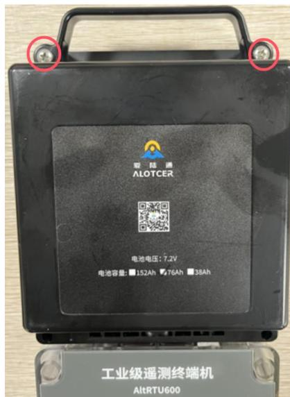
再将 2 个 M5\*60mm 的螺丝装入靠近主机的螺丝孔内，并用十字螺丝刀锁紧。
