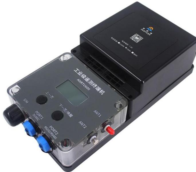
AItRTU600P 是基于无线通信技术研发的 IP68 防护等级、低功耗、防腐防爆的高性能工业级管网遥测终端机/数采仪。产品采用高性能的工业级 32 位通信处理器和工业级无线模块，以嵌入式实时操作系统为软件支撑平台，实现数据采集、存储、显示、控制、报警、远程传输和远程管理等综合功能。
