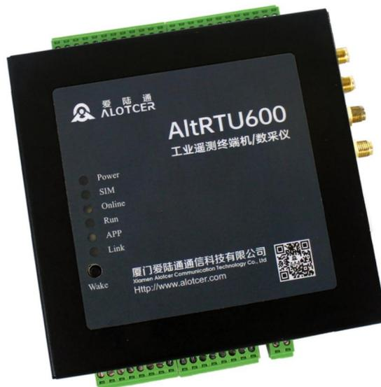
AltRTU600L 是基于无线通信技术研究的工业遥测终端机/数采仪。产品采用高性能的工业级 32 位通信处理器和工业级无线模块，以嵌入式实时操作系统为软件支撑平台，实现数据采集、存储、显示、控制、报警、远程传输和远程管理等综合功能。
